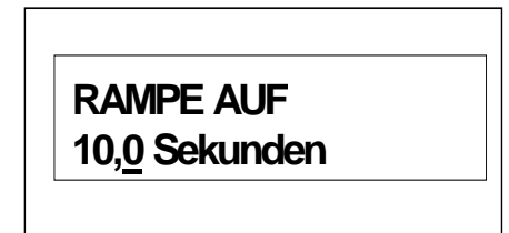
Position des Cursors unter der zu ändernden Dezimalstelle
